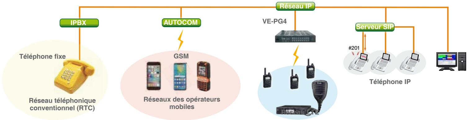
La passerelle VE-PG4 peut être utilisée pour permettre une interconnexion avec les réseaux téléphoniques (téléphones fixes, GSM, téléphone IP). Dans ce mode il est à la fois possible de recevoir des appels de l'extérieur directement sur les radios et d'appeler des numéros pré-programmés à partir de chaque poste radio.
