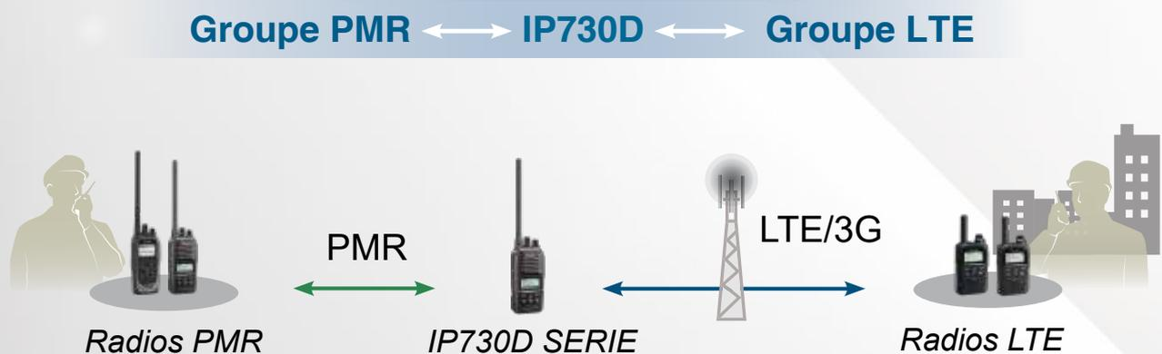
La fonction "bridge" assure également l'établissement ponctuel d'une connexion entre deux réseaux PMR distants même en cas d'utilisation de fréquences ou de canaux différents.
