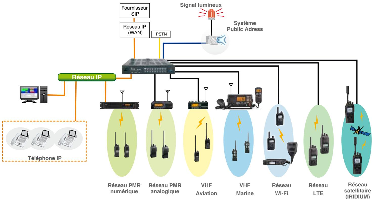
La passerelle VE-PG4 permet d'interconnecter des réseaux utilisant différentes technologies de communication (PMR VHF/UHF, VHF aviation, VHF marine, réseaux LTE (4G), réseaux IP, serveurs SIP, etc.)
